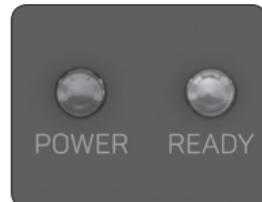
Energieleuchte (Erwärmung): zeigt, dass Ihr Gerät an ist und sich erwärmt (rot)
